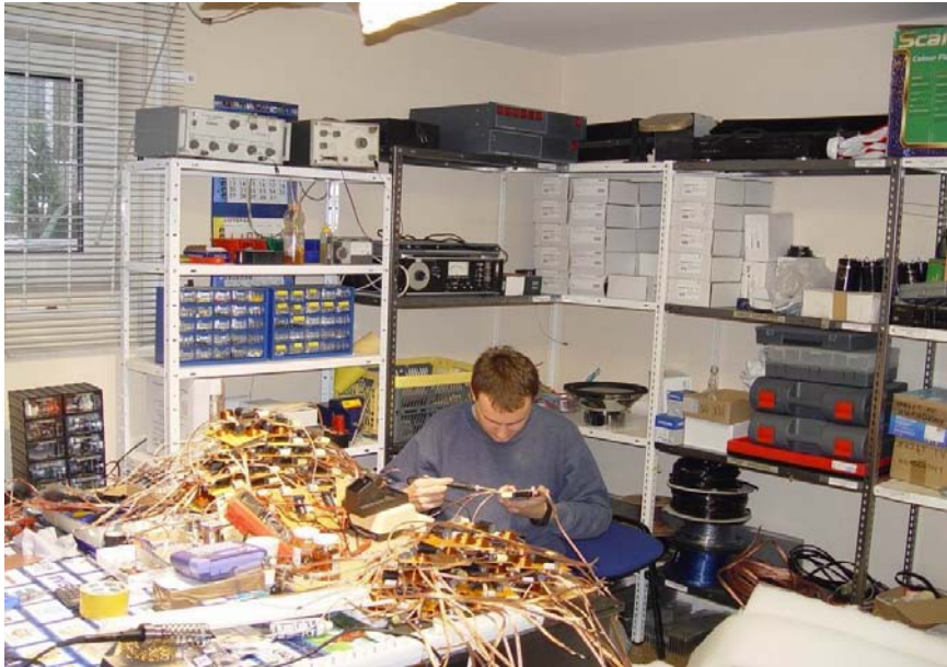
Montaż elementów zwrotnic pasywnych
